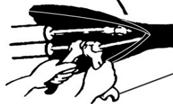
гайковий ключ з обмеженням по обертовому моменту
