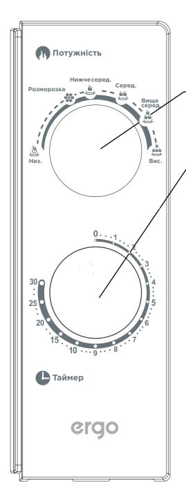
Панель управления состоит из двух функциональных частей: шарообразная ручка выбора мощности и ручка таймера.
